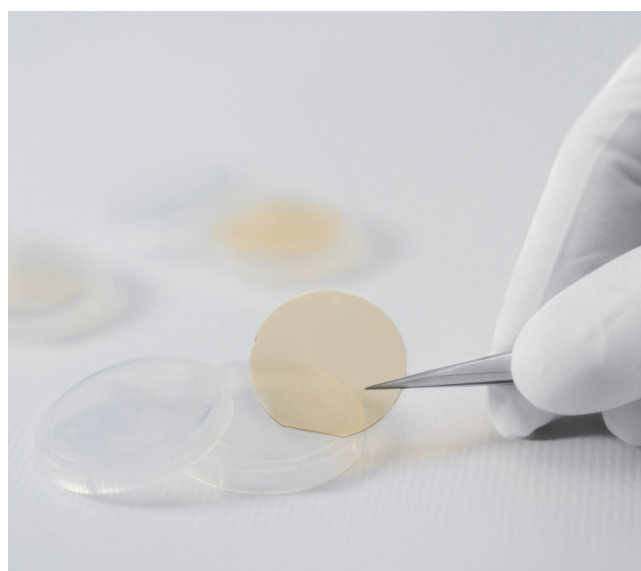
Ein fertiggestellter 1-Zoll-AlN-Wafer nach dem Polieren [1 Zoll = 25,4 mm] (Bild: Elisabeth Iglhaut / IISB)
